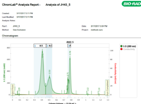
Рис. 2. Результаты гельпроникающей хроматографии, полученные для отдельных белковых фракций различных сортов грецкого ореха. Колонка для гельпроникающей хроматографии Enrich 750, элюент – деионизованная вода, скорость потока 1 мл/мин.
