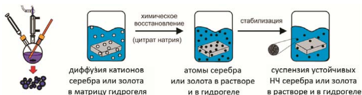
Рис. 2. Синтез наночастиц серебра или золота в гидрогеле целлюлозы
