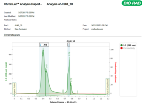
Рис. 2. Результаты гельпроникающей хроматографии, полученные для отдельных белковых фракций различных сортов грецкого ореха. Колонка для гельпроникающей хроматографии Enrich 750, элюент – деионизованная вода, скорость потока 1 мл/мин.
