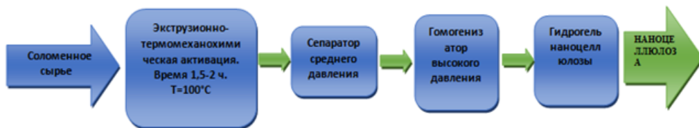
Рис. 2. Обобщенная схема способов получения НЦ.
